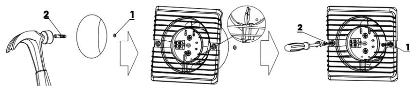
En ventiladores con control electrónico, es posible configurar los parámetros de funcionamiento del dispositivo en un potenciómetro rotativo mediante un destornillador (versiones TS, HS y MS)
