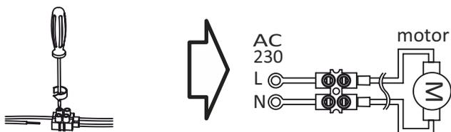
TS\HS و MS\HS والتوصيل الكهربائي للإصدار
