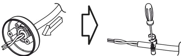
التوصيل الكهربائي للإصدار
