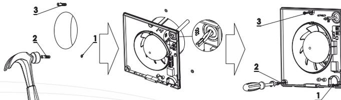
Le potentiomètre des ventilateurs dotés d'une régulation électronique peuvent être réglés à l'aide d'un tourne-vis (version TS, HS, MS)
